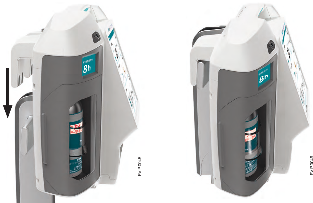
図 5-8 INO マウント 1TバーへのEVOLVE DS の取り付け：前（左）と後（右）
