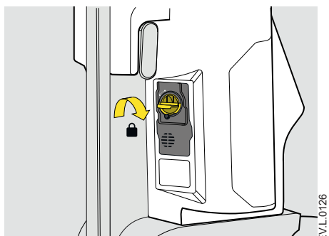
図6-19 つまみを回して新しい eINocal モジュールを本体に固定する
