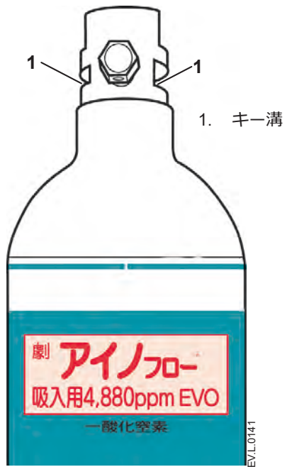
図3-10 ポンベバルブ本体のキー溝
