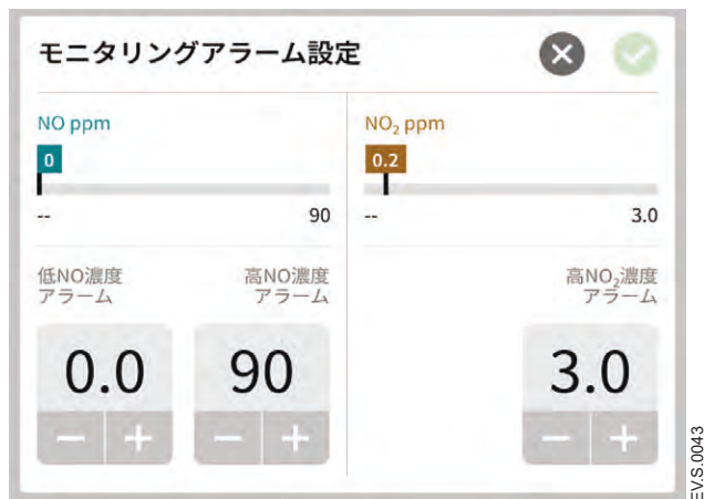
図 2-5 投与濃度設定前におけるデフォルトの NO および NO 2 アラーム上下限値
