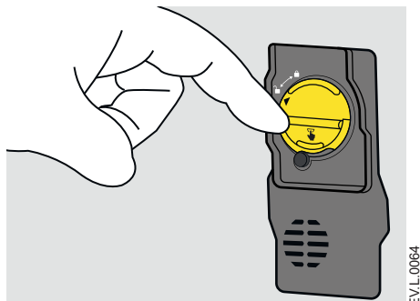
図6-17 つまみを回して新しい eINocal モジュールのくぼみから出す
