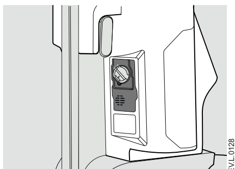
図6-21 新しい eINocal モジュールの設置完了
