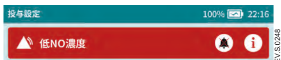
図 7-5 重要度高アラーム発報中、アラーム消音ボタンがアクティブ
