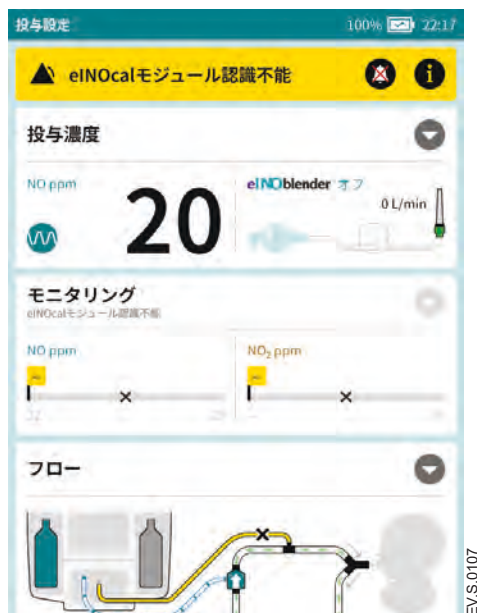
図6-7 [eINOCalモジュール認識不能] アラームが表示されているメインディスプレイ
