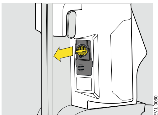
図6-13 eINocal モジュールを取り外す
